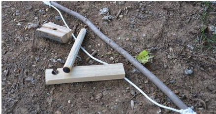
Outillages pour utiliser la méthode de la perceuse d'arc.
